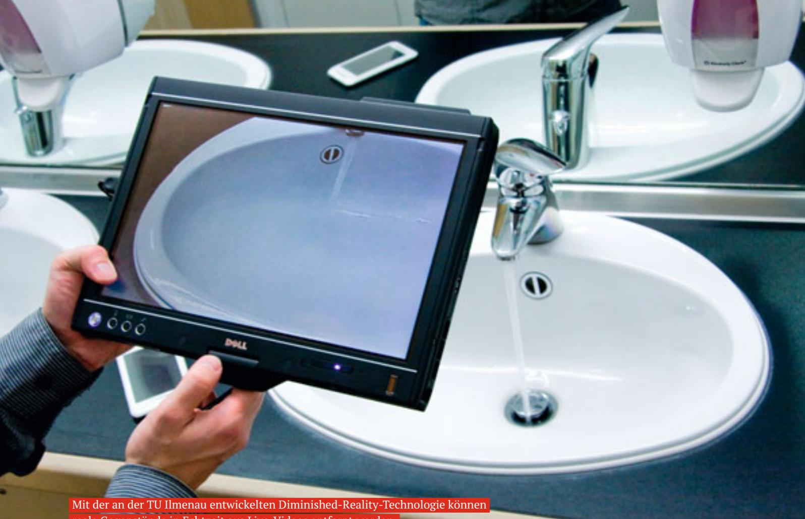
Mit der an der TU Ilmenau entwickelten Diminished-Reality-Technologie können reale Gegenstände in Echtzeit aus Live-Videos entfernt werden.
